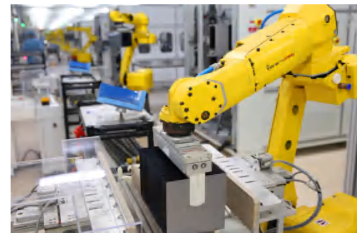
扬州协鑫光伏科技有限公司 黑硅车间机器人自动上下料流水线
